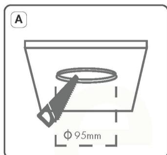
Realice el corte según el diámetro indicado para la instalación de la bala GU10
