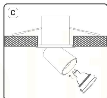
Retire el aro frontal e instale el bombillo GU10 en el socket, luego instale todo junto con el aro frontal
