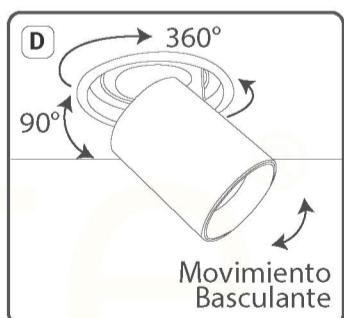
Direccione el haz de luz con el sistema multidireccional hacia la posición deseada.
